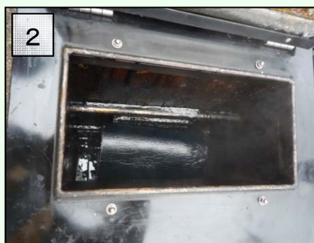
2 T. Cメルター内にシール材を 投入して加熱を開始
